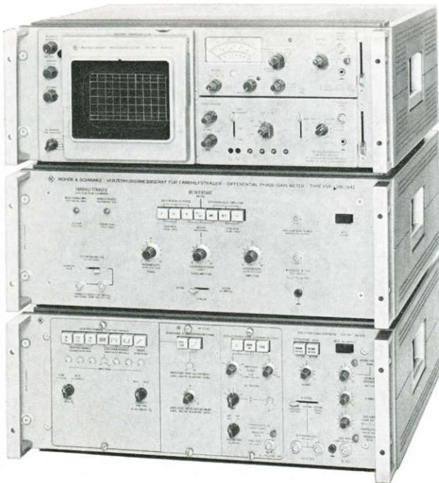
Meßaufbau für die Messung der differentiellen Phase und Amplitude mit Verzerrungsmeßgerät PVF, Meßoszillograf OMTF (oben) und Video-Prüfsignalgenerator SPF (unten) mit Einschub »Zusatzsignal für Verzerrungsmessung«
