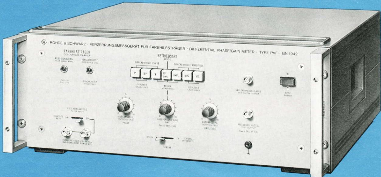
Ein Gerät zur Überprüfung und Messung nichtlinearer Verzerrungen des Farbhilfsträgers in Fernseh-Übertragungssystemen.
